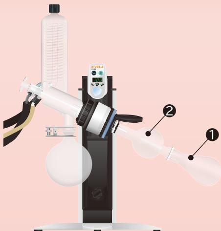
ロータリーエバポレーター 純正パーティ (①試料フラスコ、②トラップ球) を
