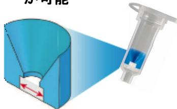
ファンネル型のリングを採用することで径の小さいシリカメンブレンを保持。高濃度溶出を実現！
