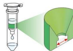
ファンネル型のリングを採用することで径の小さいシリカメンブレンを保持。高濃度溶出を実現!
