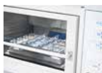
プレート培養 (φ 3mm /1000rpm)
