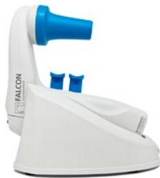
ガラスおよびプラスチック製の 0.5 mL から 100 mL のピペットで使用できる、軽量で人間工学に基づいた設計の電動ピペットコントローラーです。操作し易い位置にある速度切替ボタンとモード切替ボタンで様々な容量や粘性のある液体を扱う際に素早い操作が可能です。吸引および排出速度は操作ボタンで制御します。フル充電の状態では、6 時間連続使用可能です。天面の大きな液晶ディスプレイにバッテリー残量、ピペティングモード、速度が表示されます。
