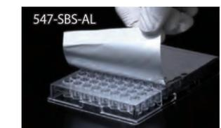
アルミニウムラミネート粘着フィルムで耐熱性と気密性に優れています。遮光できるので光に弱いサンプルの保存にも適しています。
