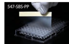
ポリプロピレン製で耐熱性がありオートクレーブ可能です。有機溶剤系に適合しています。
