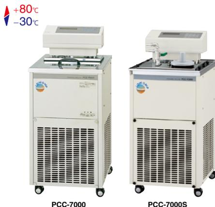
0.01°C単位の温度設定により、緩やかな温度勾配プログラム[1.0~0.1°C/min(80→10°C、水)]が可能。晶析、再結晶反応に
