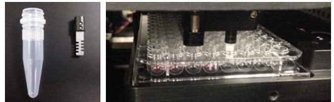
ミキサーパドルが各ウェルを測定前に攪拌
