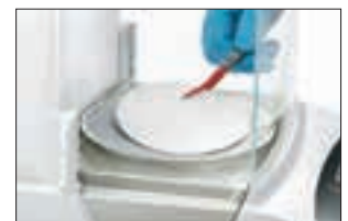
大型のフィルターや薬包紙などを静電気の影響を低減させつつ測定できるφ130 mm メッシュひょう量皿 (YFW01SQP)
