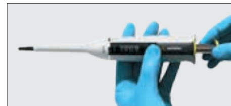
②ロック中に、ボタンを押しながら 同時に操作ボタンを回します。
