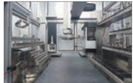
1 mg ~ 1 kg の範囲を校正可能な全自動分銅校正用ロボットシステム
