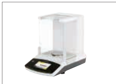
セミマイクロ天平タイプ (0.01 mg) ひょう量皿：φ80 mm 寸法：W 218 x D 376 x H 316 mm ひょう量室有効高さ：218 mm 重量：7.8 kg
