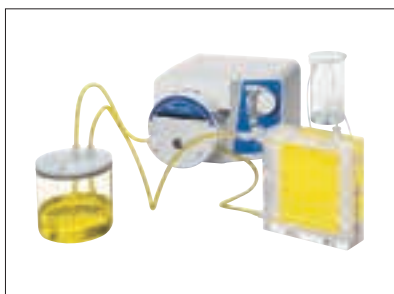
左:ダイアフィルトレーションリザーバー 中央:マスターフレックスペリスタポンプ 右:ビバフロー-200
