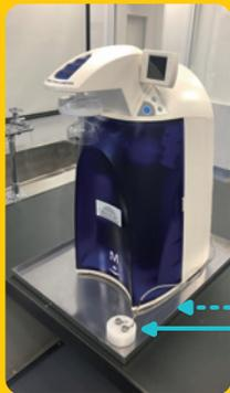
天災や万が一の故障などによる、装置の漏水被害を最小限に抑えます。
