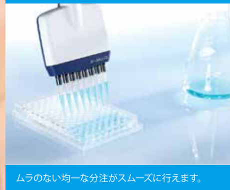
ピッチ間隔が変えられ、チューブやウェルの大きさが異なるプレートへの分注が効率よく行えます。
