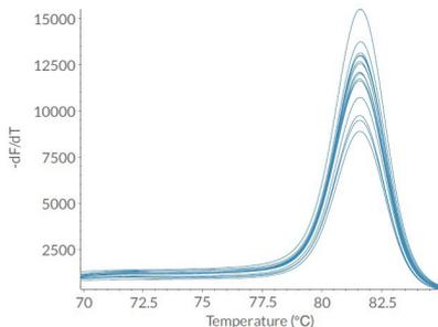
10,000コピーのウイルスDNA(16試料)のPCR反応とTm解析結果。Tm値の平均は81.7°C, SDは0.015°Cと、ブロック間での温度均一性が高い。
