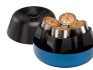
JLA-9.1000 最高回転数: 9,000rpm 最大遠心力: 16,800xg 容量: 4×1,000mL
