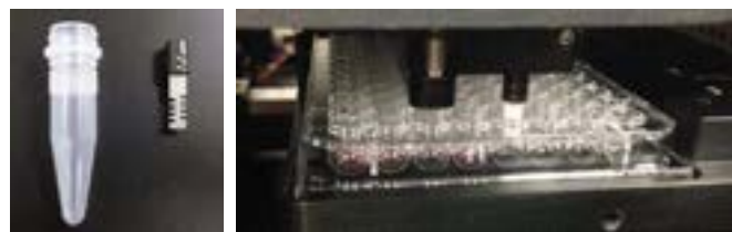
ミキサーバドルが各ウェルを測定前に攪拌
