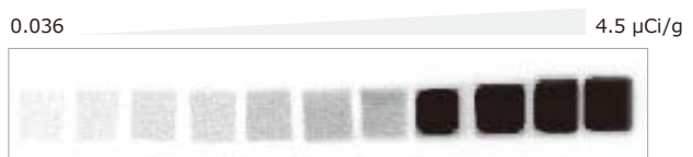
American Radiolabeled Chemicals 社の Carbon-14 スタンダードをストレージフォスファースクリーンで 3 時間露光した後、Sapphire Biomolecular Imager で撮影したものの。
